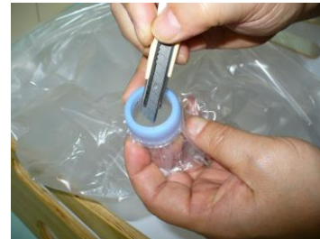
○蓋をねじ込んだ時に生じたビニールのシワを調整し、カッターで蓋の内側に穴を開ける
