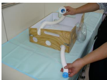
○内側から排水口に排水ホースを通し、排水の受け口をカチッと排水穴に固定する
