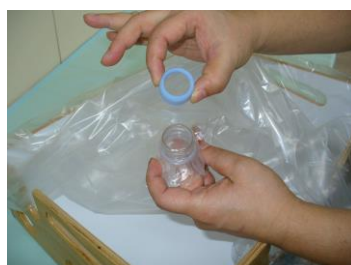
○差し込んだ位置で、ビニールシートをかぶせたまま取り出し、排水用ラップ口の上から、蓋を奥まで完全にねじ込む
