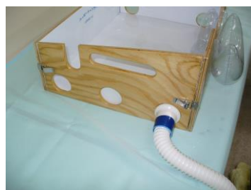
○内側から排水口に排水ホースを通し、排水の受け口をカチッと排水穴に固定する
