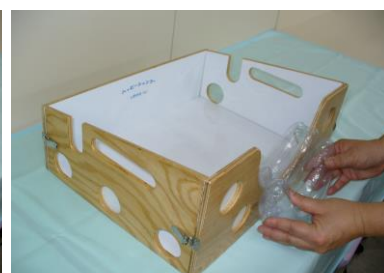
○空気枕を設置する(細い方が内側)
